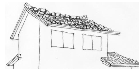
棟瓦が全面的にずれ、破損あるいは落下している。棟瓦以外の瓦のずれも著しい。
